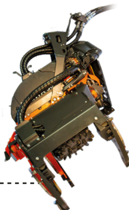
Fixe Schneiden an den Greifzangenspitzen erhöhen den Entastungsbereich
