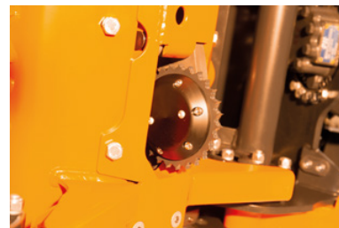
Schnelle Reaktion des Längen- messrades: Kein Bewegen einer Ölsäule während des Messvorgangs
